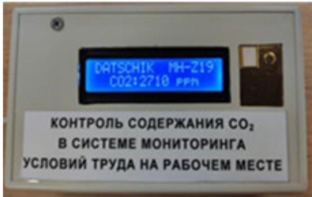
Рис. 6. Усовершенствованный макет на основе датчика MH-Z19
