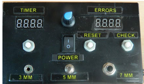
Рис. 3. Макет для оценки тремометрии
