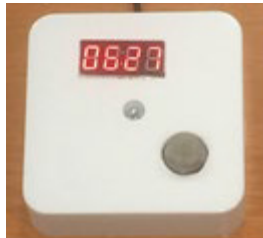
Рис. 3. Вариант макета на основе датчика серии MQ
