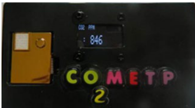
Рис. 5. Макет на основе датчика МН-Z19
